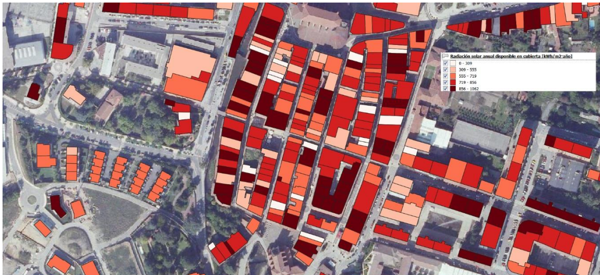
Figura 4: Indicador de radiación solar sobre cubierta de edificios del casco histórico de Durango (Fuente: elaboración propia)
